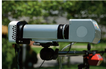
国内首套地面成像光谱辐射计, 在 hyperspectral 遥感机理研究、食品安全、文物保护、目标探测等方面得到广泛应用
