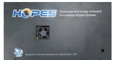
国内首套高光谱图像星上实时处理实验系统 (HOPES), 首次实现了高光谱图像获取与处理过程的同步进行
